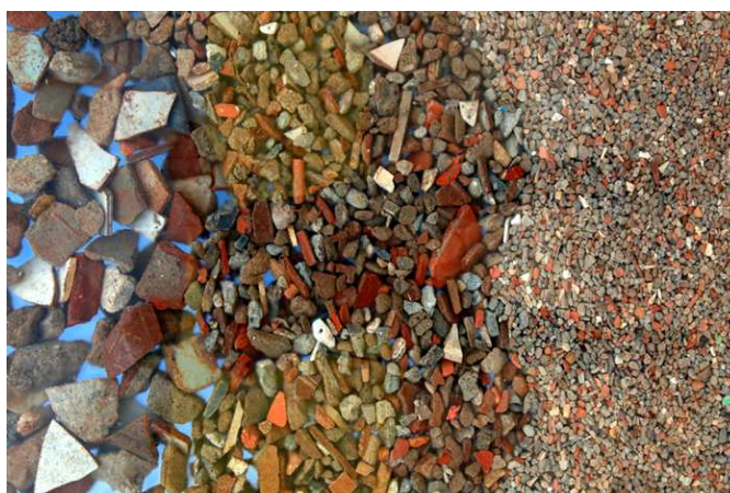
Figura 4: Etapas da reciclagem dos resíduos de classe A. Fonte: PROGUARU (2014).
